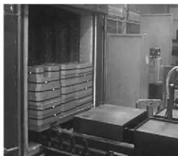
Horno de Tratamiento Térmico de los Núcleos Enrollados.
